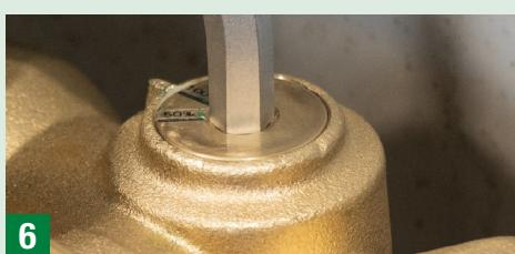
**1 POSITIONIEREN** Sie unter Beachtung der Fließrichtung den Einbauflansch.
